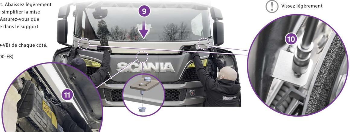
12. Poussez le Pare Perroquet sur le côté et serrez en même temps la vis (160IF3500-VB) avec du 7Nm.
