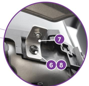
9. Installez le Pare Perroquet. Abaissez légèrement la trappe de service pour simplifier la mise en place de l'accessoire. Assurez-vous que la goupille fileté s'insère dans le support central du camion.
